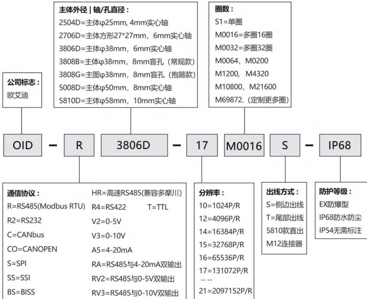
**例：**OID-R3808B-16M0016S-IP68 表示 RS485 总线输出，主体外径 38mm，8mm 盲孔，分辨率 16 位（65536P/R），圈数 16 圈的多圈绝对值编码器，侧边出线（默认 1 米线缆），IP68 防尘防水。
