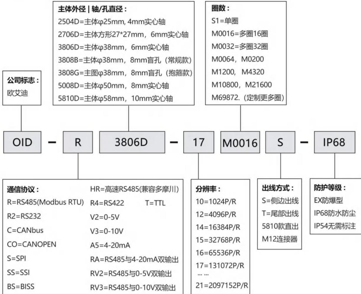
**例：**OID-R3806D-15S1S-IP68 表示 RS485 总线输出，主体外径 38mm，D 型实心轴 6mm，分辨率 15 位（32768P/R），单圈绝对值，侧边出线（默认 1 米线缆），IP68 防尘防水。
